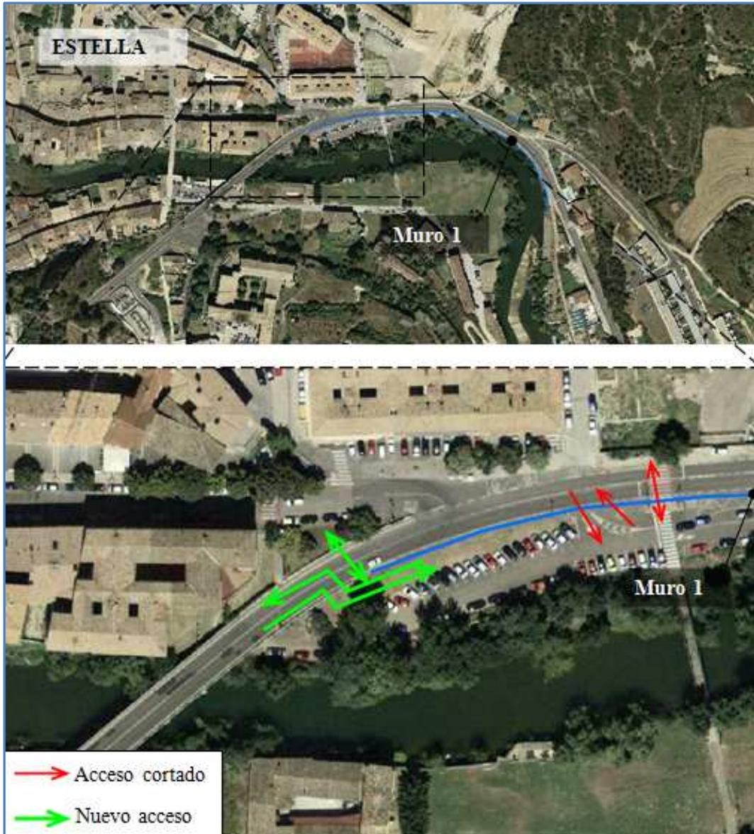
*Disposición en planta del Muro 1 en el municipio de Estella (NA-1110) y reordenación de accesos.*
